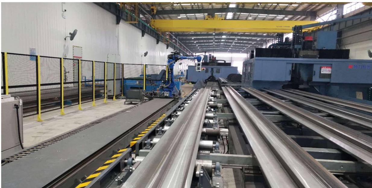
传统的生产方式采用单一设备刀加工作业，生产耗时长，资源浪费严重，制造精度及生产效率低，一根 F 型钢加工至少需要 9 个小时才能完成。现通过这条流水线，单根 F 型钢几个面可以同时加工，加工时间不超过 40 分钟，相比传统加工模式下轨排变形 2 毫米，而 F 轨智能生产线加工的轨排变形均控制在仅 0.5 毫米以内，且占用设备及人工少。
