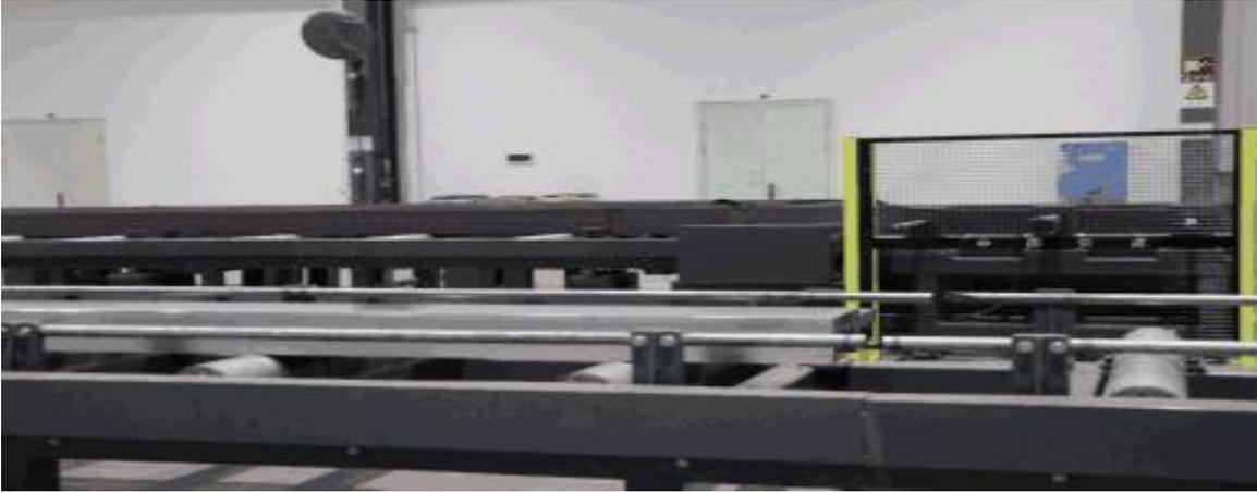
H型钢轨生产线由两台数控机床，配备毛坯上料辊道、卸料机构、机动滚道输送、翻转机构、储料机构、清理切屑装置、自动定位装夹夹具、安全护栏、控制系统等部件组成。主要用于完成数控铣端面、钻孔、铣腰型孔加工，可实现工件自动上下料、自动定位装夹、可选程序自动数控加工、工件自动翻转、工件检测、自动去飞边、毛刺，刀具磨损在线统计分析。具有布局合理，结构紧凑，节省场地，物流顺畅，有较高的自动化程度，可针对不同品种零件自动适应加工、能实现设备故障自动报警、刀具寿命自动预警的功能。
